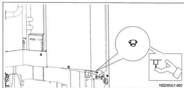
Bild 14 Återställningsknapp för överhettningsskydd (tryck uppåt).
